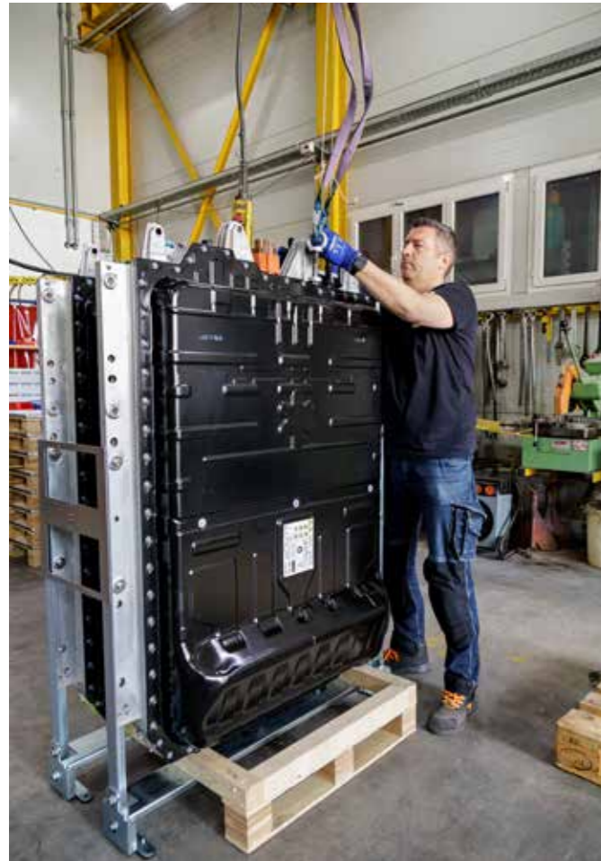
In ihrem ersten Leben ausgediente Autobatterien erhalten nach intensiver Prüfung ein neues Leben als Second-Life-Modul (von oben).
