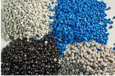
Mit «Bring Plastic back» wird der Haushalt-Kunststoff rezykliert und zu Regranulat verarbeitet.
