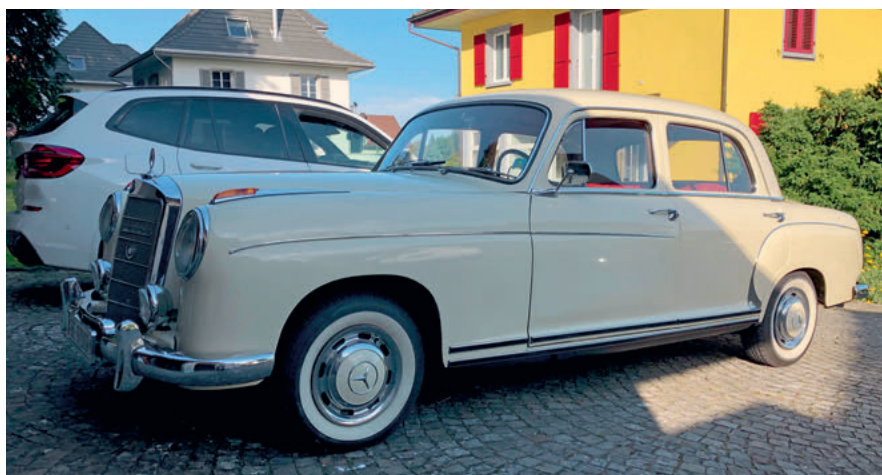
Mercedes Benz 220 S, Jahrgang 1956, 6 Zylinder, Hubraum: 2195 ccm, zwei Vergaser, 100 PS, 4 Gänge, Spitze 160 km/h und ausgestattet mit einem roten Lederinterieur.
